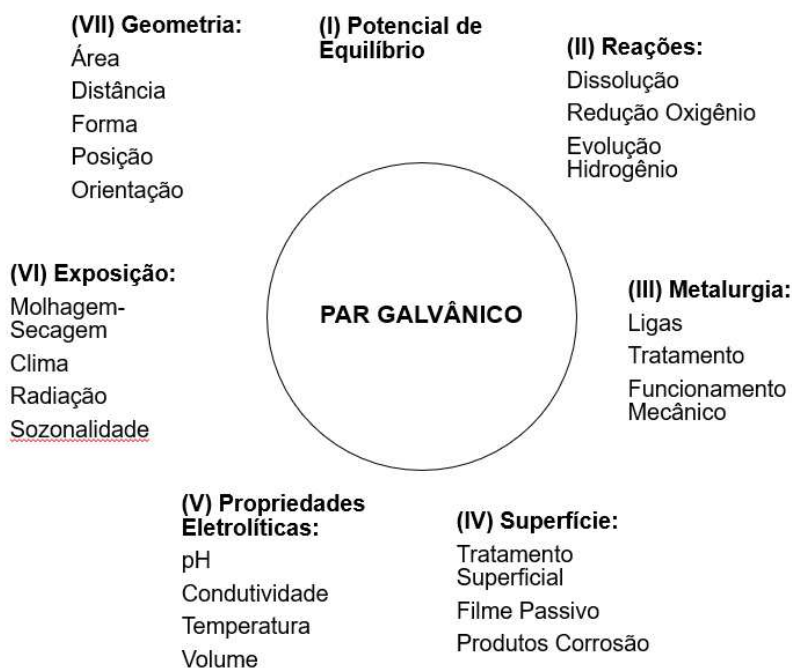
Figura 9: Fatores intervenientes no processo de corrosão galvânica.
