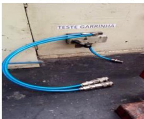
• SISTEMA PARA TESTES DE SENSORES DE CHAPA DUPLA
