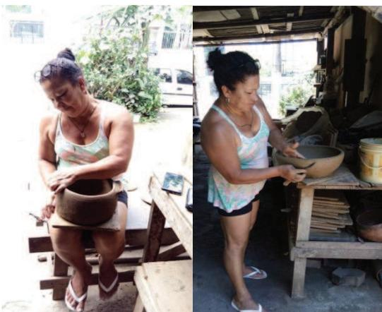
Imagens 67 e 68: Cileida alisando caldeirão; terminando de levantar a panela com auxílio da faca.
