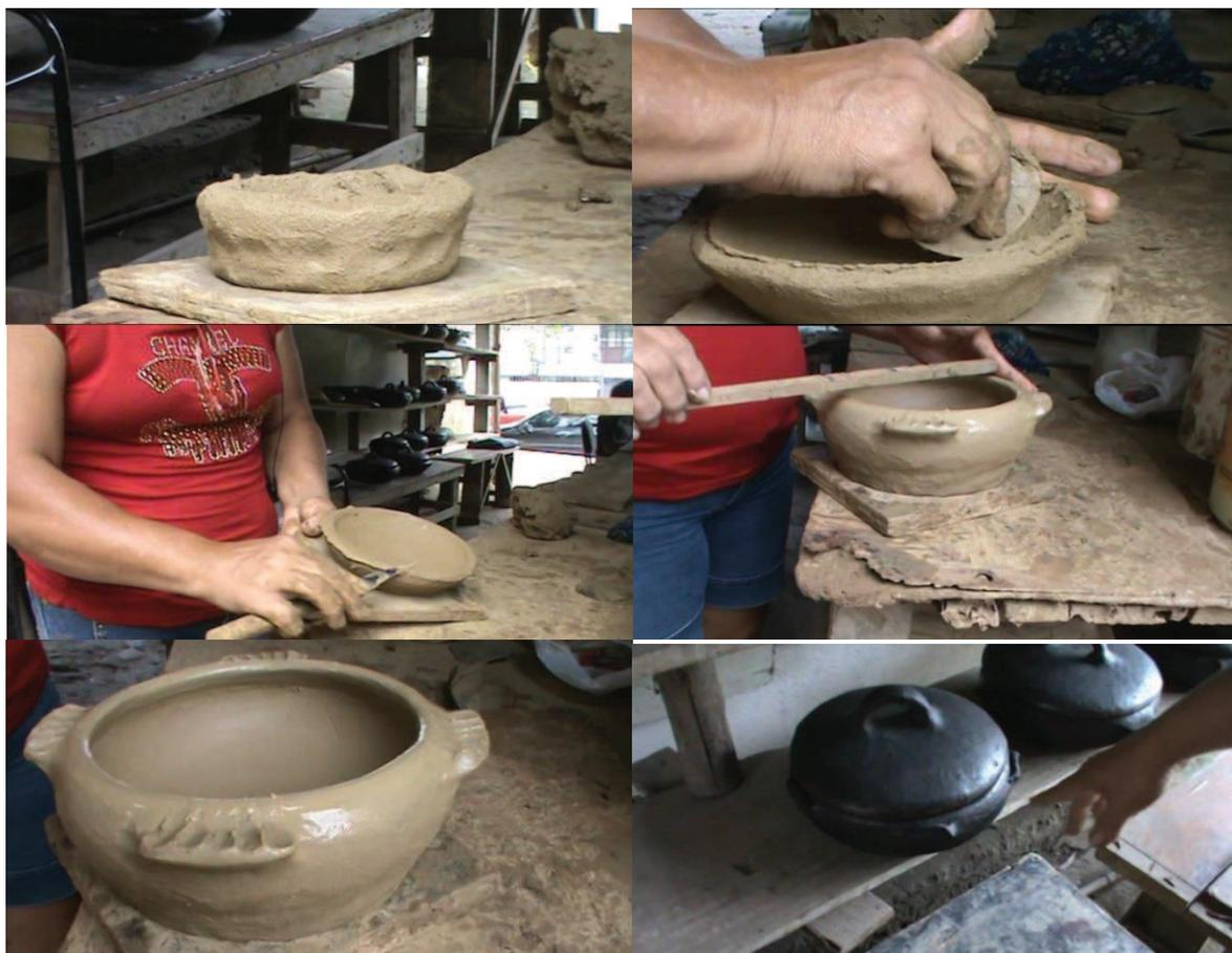
Imagens 69 a 74: Abertura da bola de barro na plataforma de madeira; acabamento na tampa; acabamento na tampa realizado com a faca; conferência do tamanho da boca da panela; panela com pegadores de caldeirão; panela com o pegador na forma de “orelhinha”.
