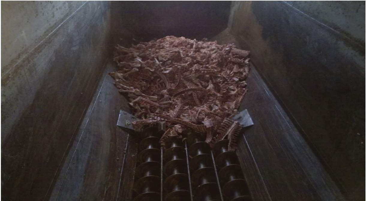
Figura 5 – Tolva Grande (FOTO BEN HUR AGROINDUSTRIAL S/A) Fonte: Foto BEN-HUR AGROINDUSTRIAL S. A.
