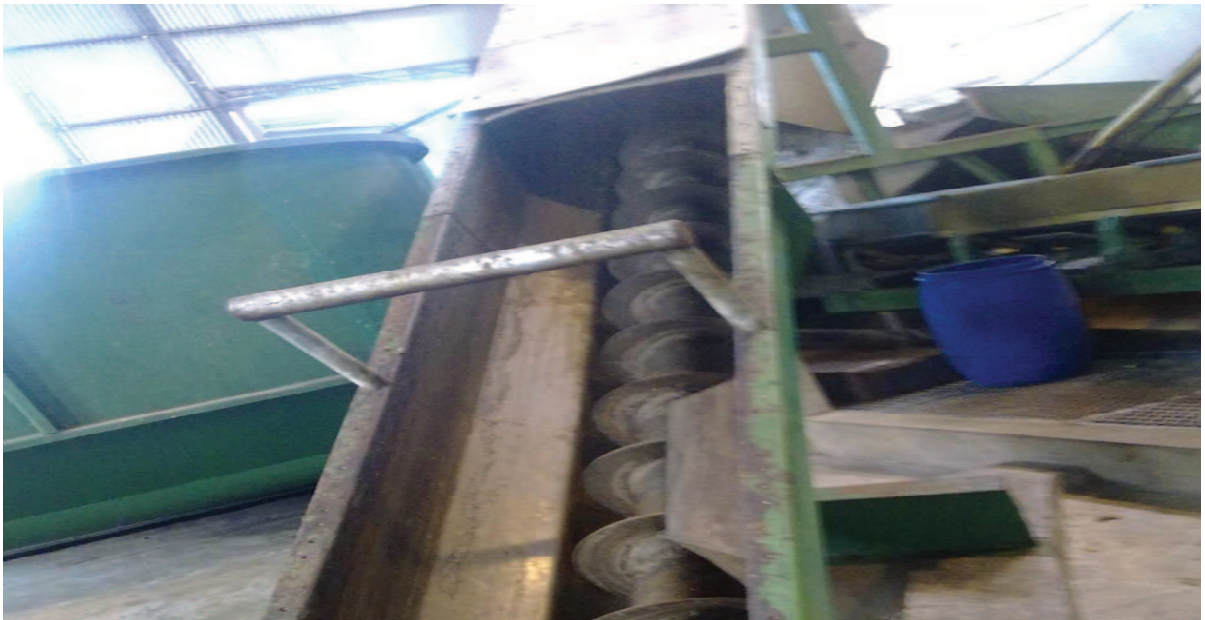
Figura 6 – Roscas Helicoidais Fonte: Foto BEN-HUR AGROINDUSTRIAL S. A.
