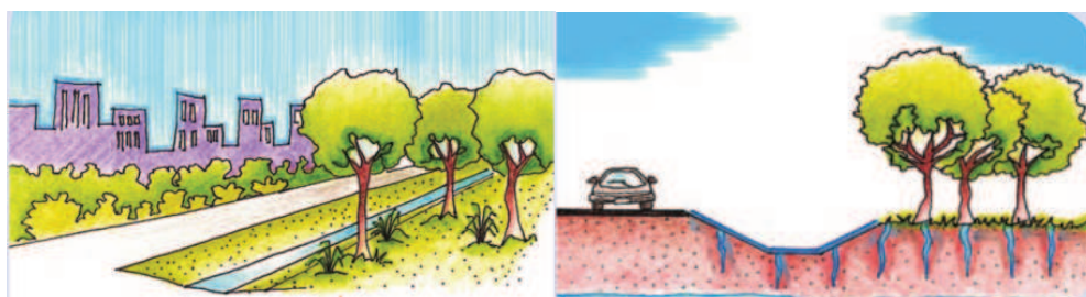
Figura 17 – Vala de Infiltração
