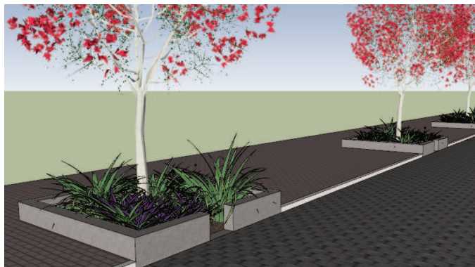
Figura 19 - Jardim de chuva em uma calçada
