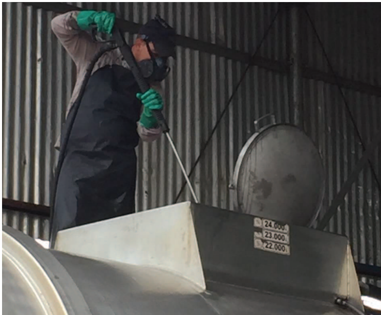
Figura 3 - Lavagem pela boca de visita superior
