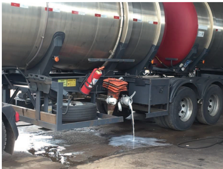
Figura 4 – Escoamento pelas válvulas API
