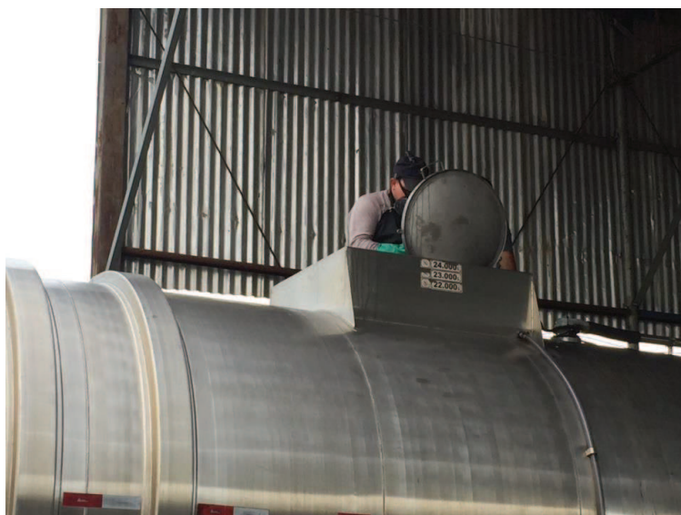
Figura 7 – Entrada no tanque para efetuar a limpeza
