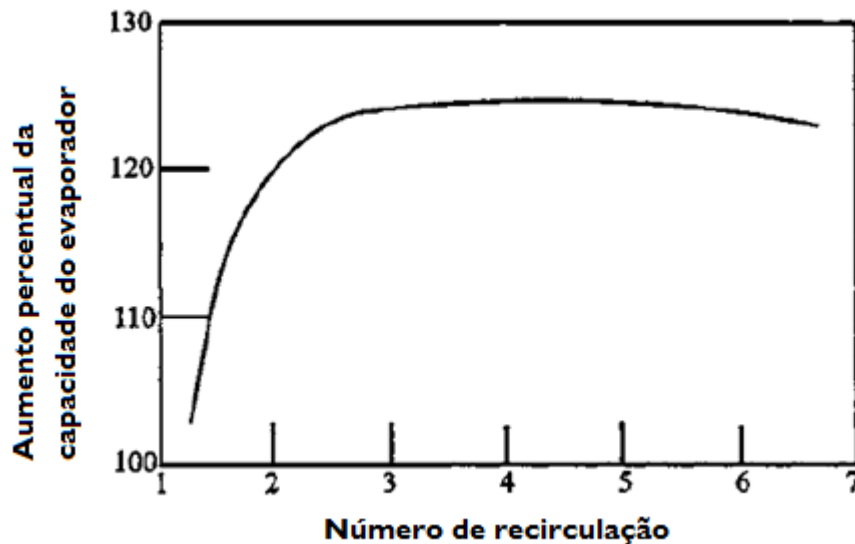
Figura 2.7 - Efeito do número de recirculação sobre o coeficiente global de transferência de calor de um evaporador resfriador de ar.
