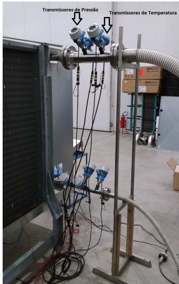
Figura 3.3 – Localizações dos transmissores de pressão e temperatura na entrada e saída do evaporador.
