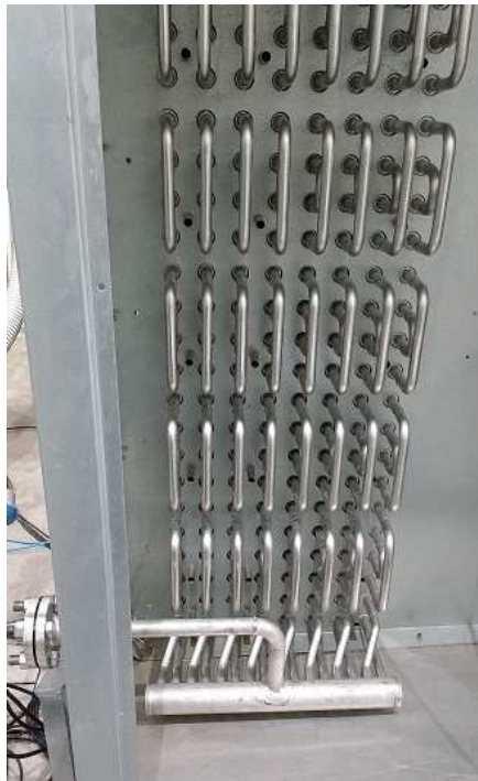
Figura 3.6 – Vista lateral do evaporador mostrando a condição de alimentação por baixo e ao distribuidor de líquido.
