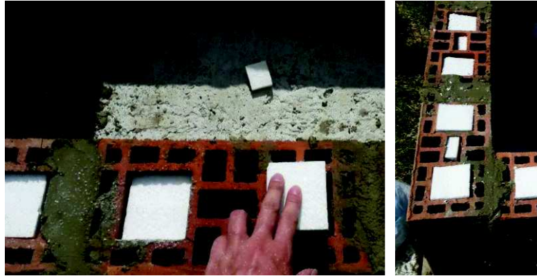
Figura 27 – Construção protótipo com preenchimento de EPS de baixa densidade (P4)
