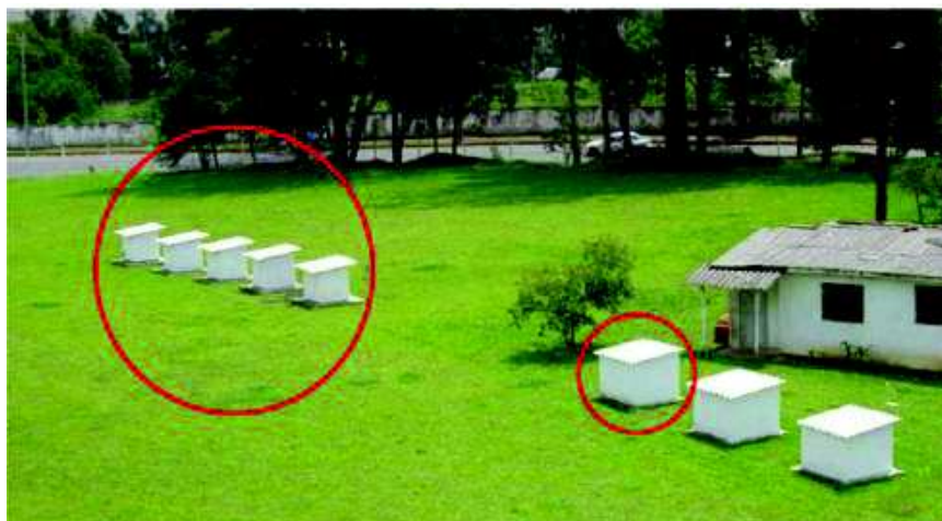
Figura 11 – Test cells com painéis de madeira e test cell referência
