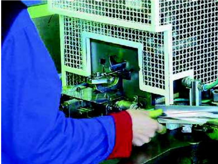
Figura 4 – Enclausuramento da Zona de Prensagem
