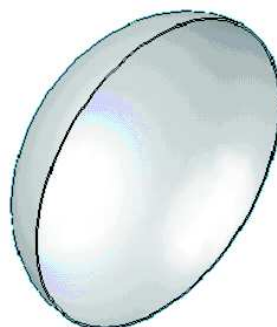
Figura 13 – Desenho 2: Tampo Semi-elíptico 2:1
