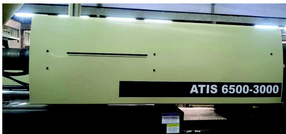
Imagem 12 – Proteção do cabeçote de injeção
