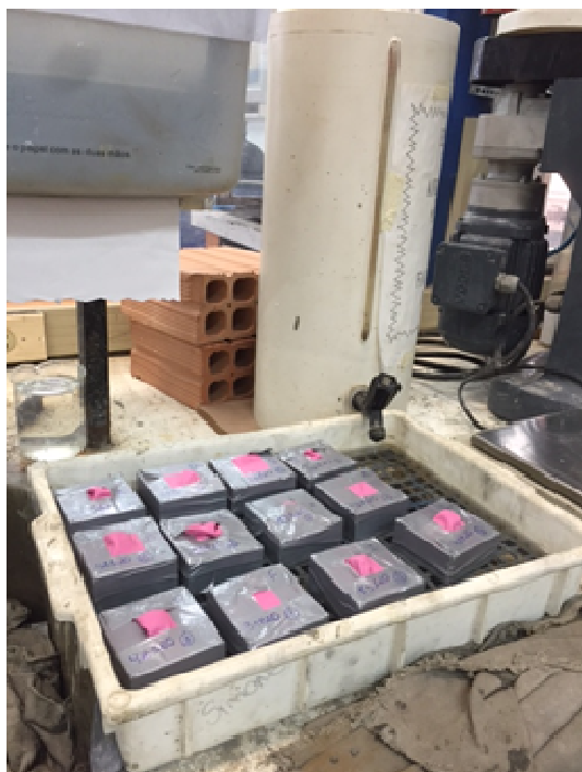
Figura 8 – Vista geral dos corpos de prova preparados para o ensaio de absorção.
