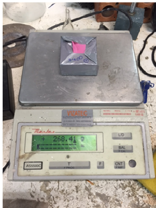
Figura 9 - Pesagem das amostras utilizadas no ensaio de absorção de água.
