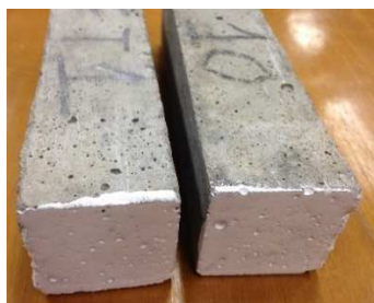
Figura 30 – Corpos de prova após aplicação de pintura epóxi em sua extremidade
