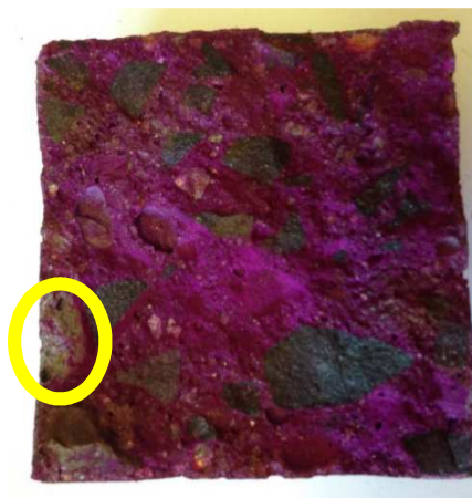
Figura 27 – Corpo de prova com frente de carbonatação não linear
