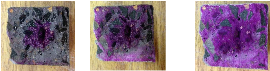
Figura 23: Verificação da carbonatação após aspersão do indicador de fenolftaleína a) 2 min b) 10min c) 20 min
