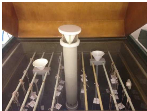
Figura 29 – Câmara de névoa salina - disposição dos corpos de prova
