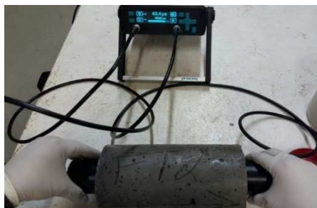
Figura 19 – Preparo da amostra e verificação da propagação das ondas ultrassônicas
