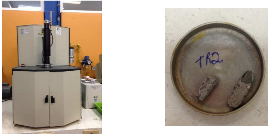
Figura 15 – Equipamento e amostra alusivos ao ensaio de porosimetria por intrusão de mercúrio
