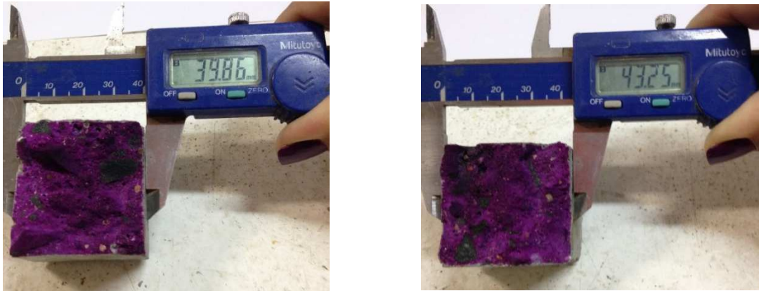
Figura 25 – Medições nas amostras submetidas ao ensaio de carbonatação acelerada
