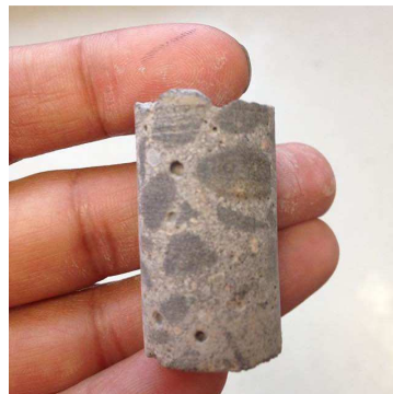
Figura 17 – Amostra extraída de corpo de prova cilíndrico para ensaio de microtomografia 3D
