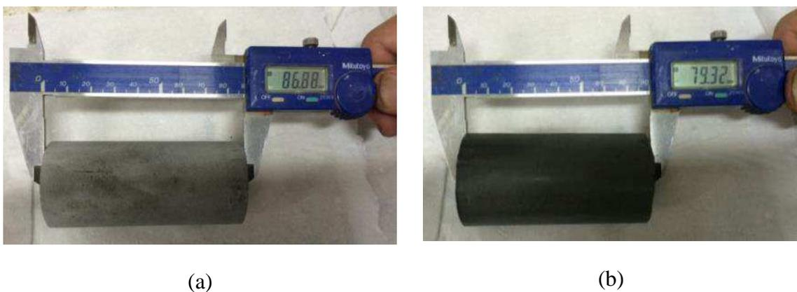
**Figura 25 – (a) Altura do corpo de prova antes da extração. (b) Altura do corpo de prova após extração.**
