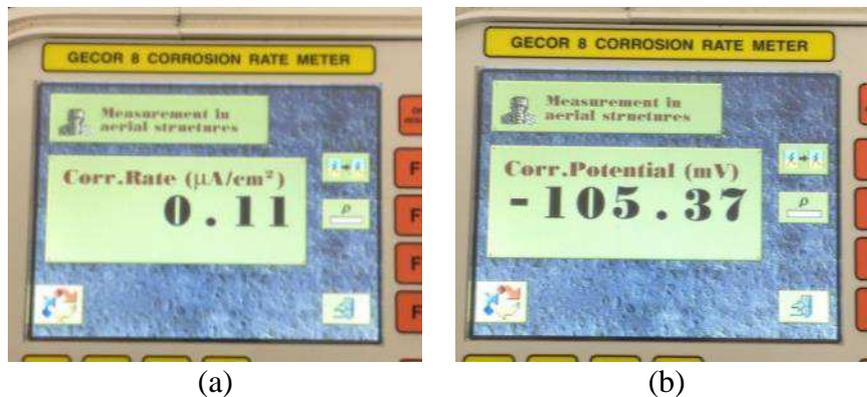
**Figura 22 – Tela com resultados (a) densidade de corrente, (b) potencial de corrosão**
