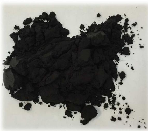
**Figura 14– Cinza obtida através da tecnologia de combustão em grelha basculante.**
