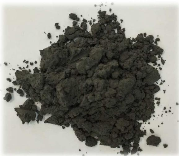
**Figura 13– Cinza obtida através da tecnologia de combustão em leito fluidizado borbulhante.**
