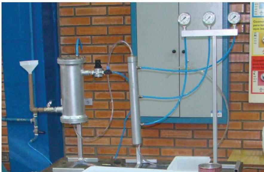
**Figura 8 – Sistema de filtração positiva**
