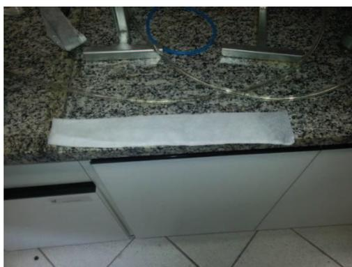
**Figura 11 – Filtro de tecido TNT utilizado no sistema de tratamento**
