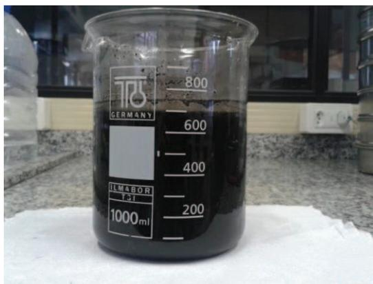
**Figura 13 – Coloração da água deionizada após passagem na CCA III, demonstrando a inviabilidade técnica, para o sistema adotado, de uso.**
