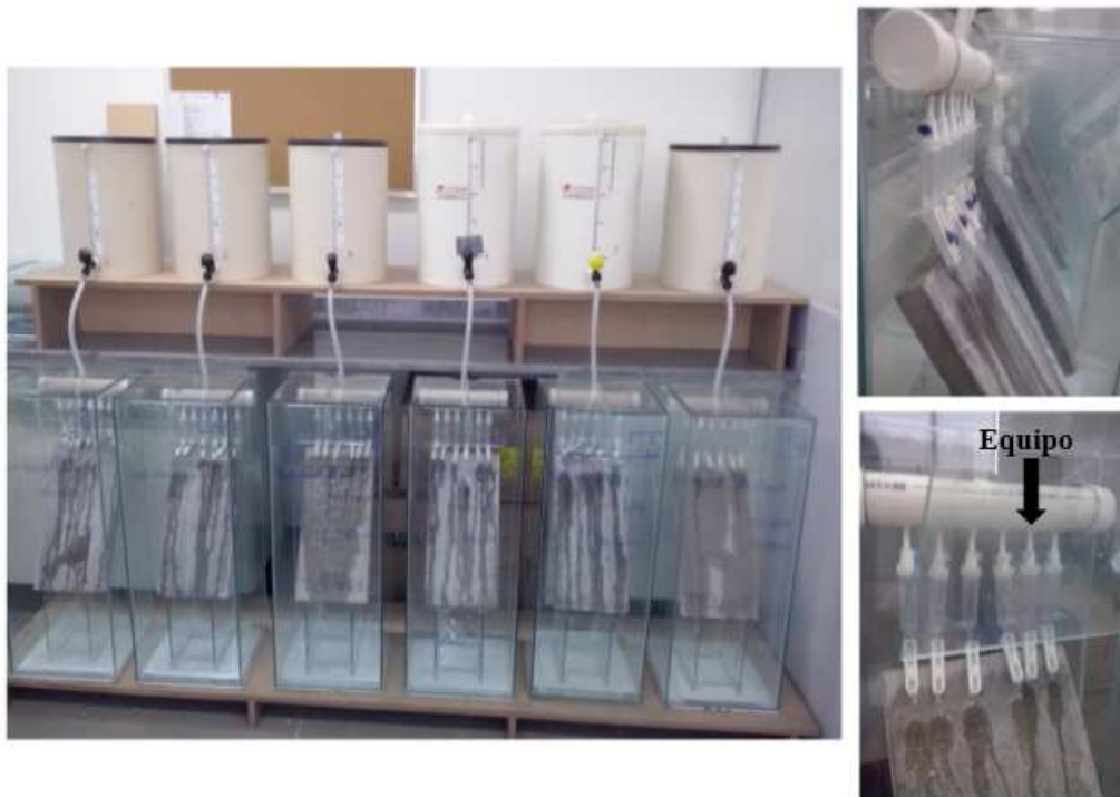
Figura 36 - Aplicação do método de lixiviação por irrigação em matriz de concreto
