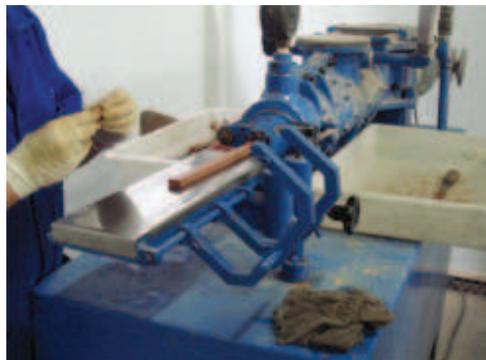
**Figura 12** - Moldagem dos corpos-de-prova
