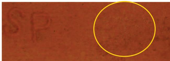
**Figura 23** – Presença de eflorescência nos blocos sem adição de lodo.
