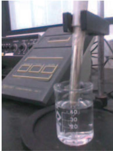
**Figura 20** – Ensaio de condutividade elétrica
