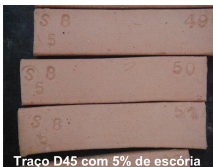
**Figura 3.9** – Corpos de prova do Traço-D45(5%) cru.
