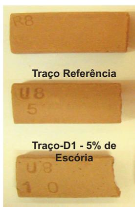
**Figura 4.11 –** Corpos de prova após a secagem.
