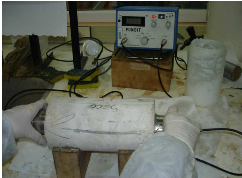
Figura 10 - Ensaio para verificação da velocidade da onda ultra-sônica.
