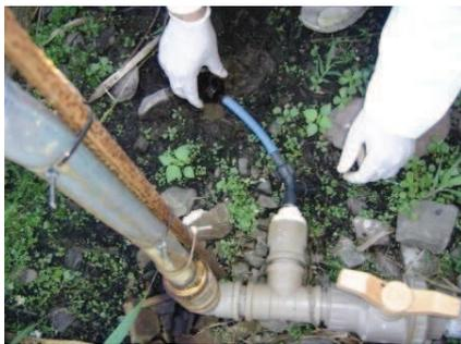
Figura 13: Saída para coleta de amostras
