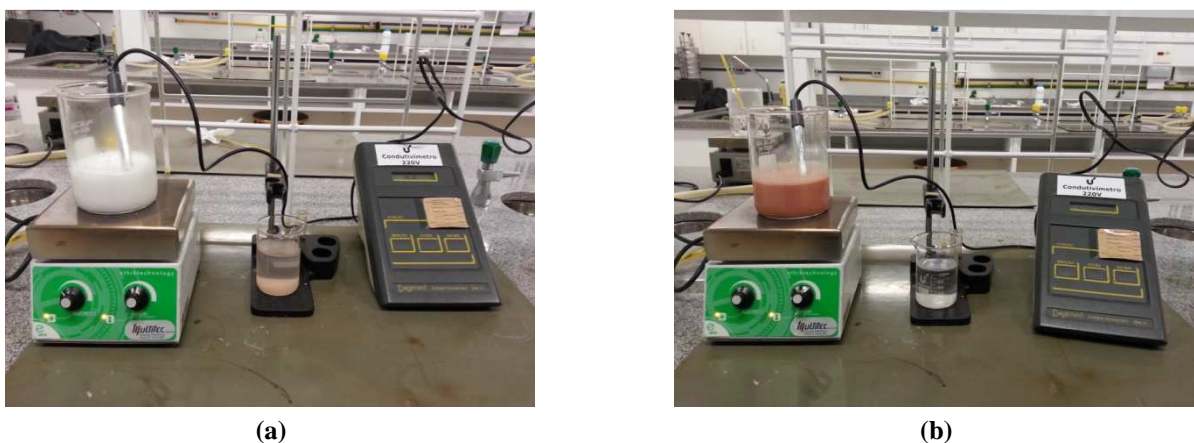
Figura 17 - Ensaio do método de Luxàn: medição da condutividade da solução de hidróxido de cálcio antes (a) e depois da adição da cerâmica 700^\circ\text{C} (b).
