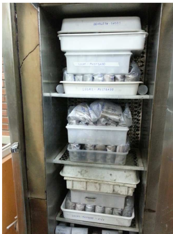
Figura 20 - Acondicionamento dos corpos-de-prova na estufa.
