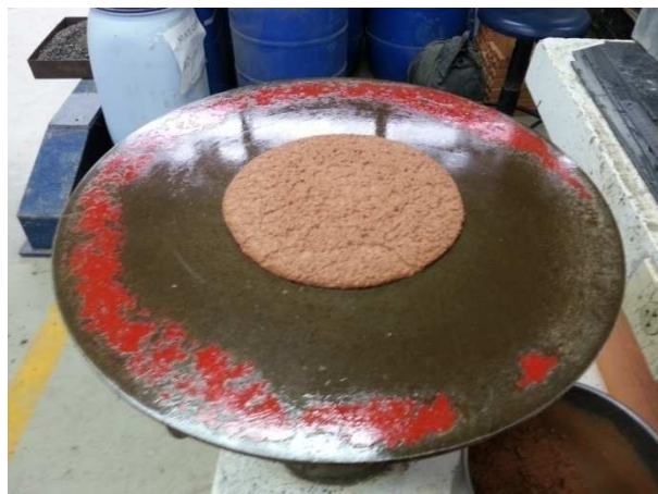
Figura 18 - Argamassa com cerâmica 700°C após ensaio de índice de consistência.
