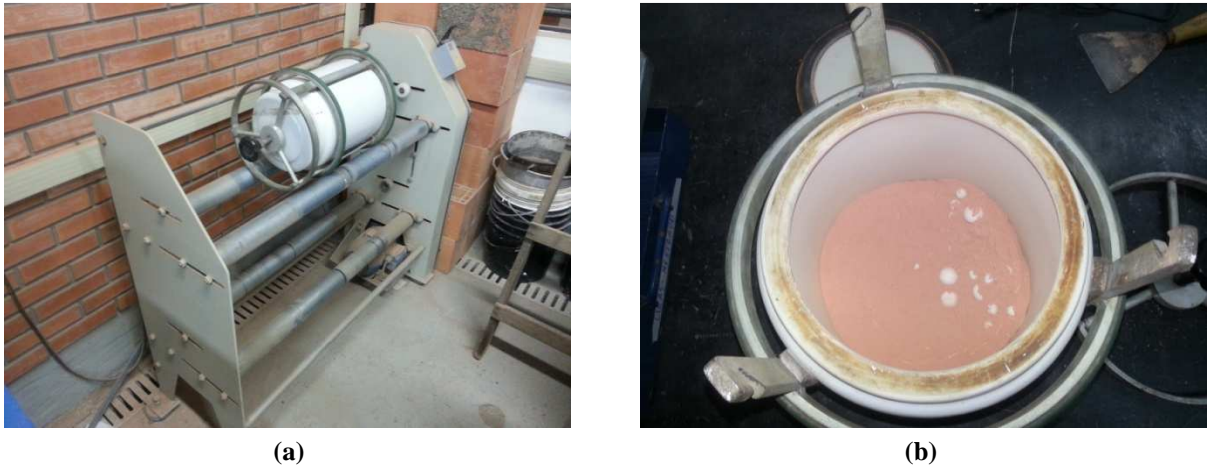
Figura 15 - Moinho de bolas (a) e detalhe das bolas de porcelana em meio à cerâmica moída (b).
