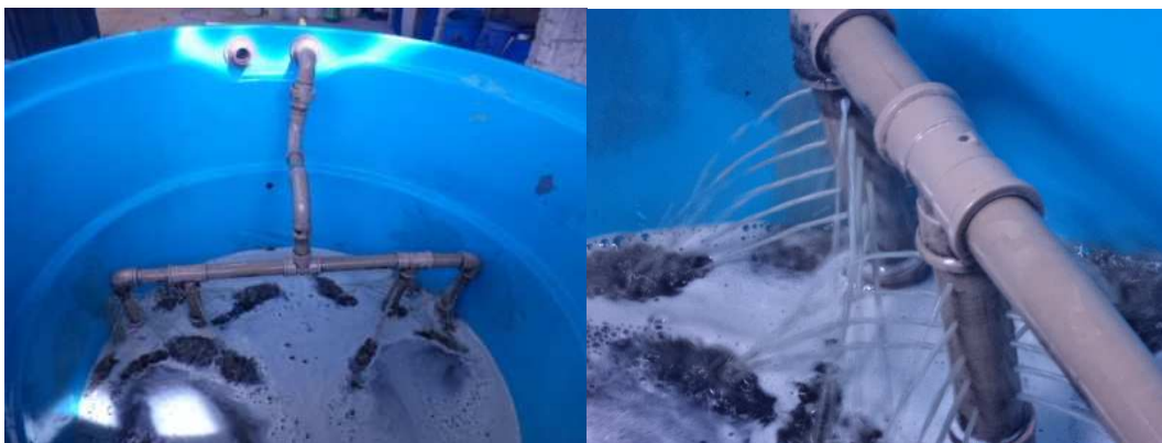
Figura 13: Tubulação perfurada usada no retorno do lixiviado para o reator
