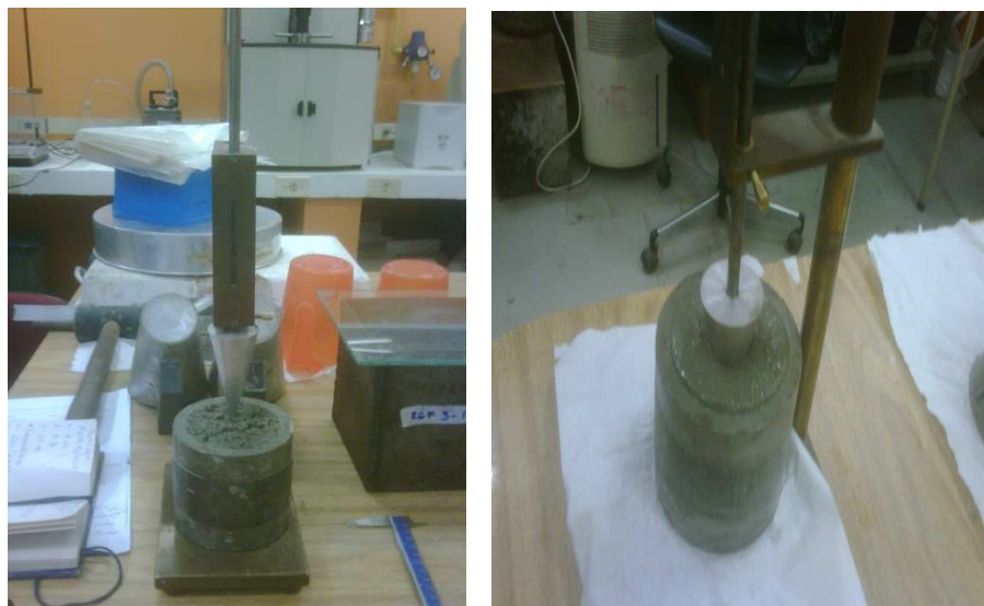
Figura 18 - Ensaio de penetração de cone.
