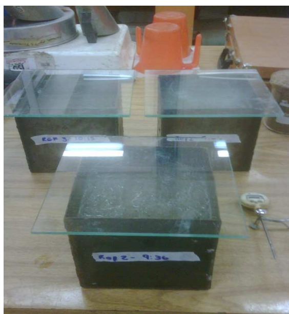
Figura 19 - Amostras para ensaio de início e fim de pega.
