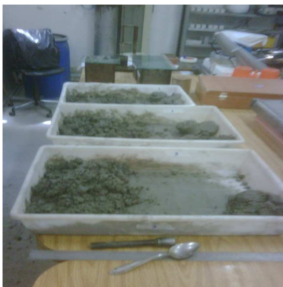
Figura 17 - Argamassas preparadas mantidas na sala climatizada.
