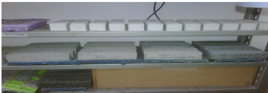
Figura 23 - Corpos de prova da resistência à tração na flexão e à compressão.
