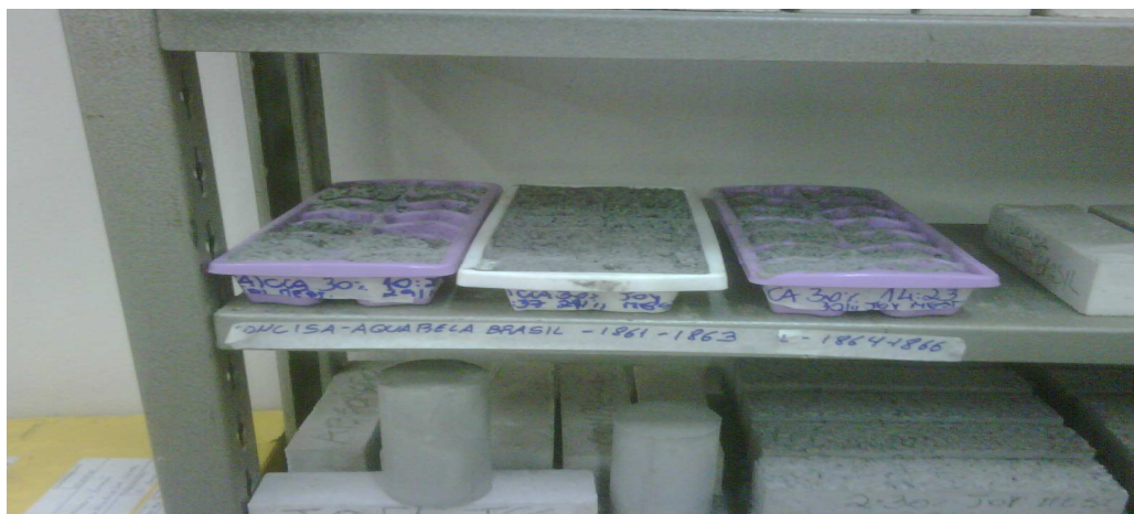
Figura 21 - Corpos de prova moldados, na sala climatizada.
