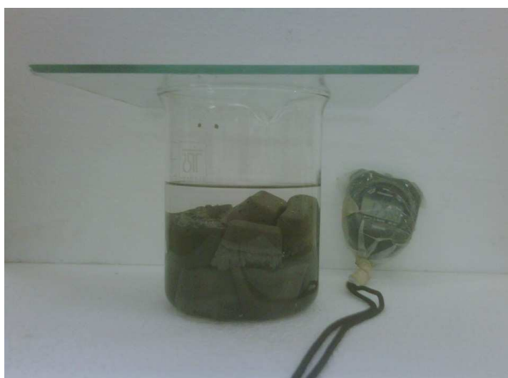
Figura 22 - Corpos de prova imersos em acetona.
