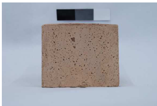
Figura A8 – Imagens digitais do traço CV0_LF10 (a) após a desforma (b) aos 126 dias de idade de exposição à intempérie.
