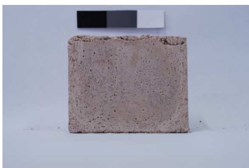
Figura A12 – Imagens digitais do traço CV10_LF5 (a) após a desforma (b) aos 126 dias de idade de exposição à intempérie.
