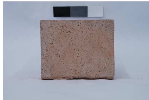
Figura A14 – Imagens digitais do traço CV10_LF20 (a) após a desforma (b) aos 126 dias de idade de exposição à intempérie.
