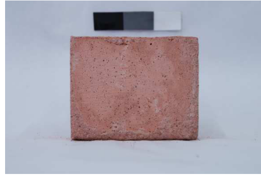
Figura A21 – Imagens digitais do traço CV20_PG1 (a) após a desforma (b) aos 126 dias de idade de exposição à intempérie.
