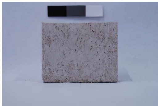
Figura A5 – Imagens digitais do traço REF (a) após a desforma (b) aos 126 dias de idade de exposição à intempérie.
