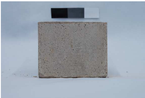
Figura A18 – Imagens digitais do traço CV20_LF5 (a) após a desforma (b) aos 126 dias de idade de exposição à intempérie.
