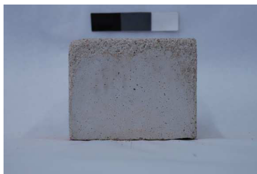
Figura A11 – Imagens digitais do traço CV10 (a) após a desforma (b) aos 126 dias de idade de exposição à intempérie.
