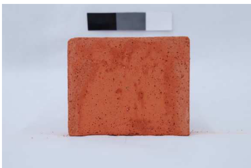
Figura A16 – Imagens digitais do traço CV10_PG5 (a) após a desforma (b) aos 126 dias de idade de exposição à intempérie.
