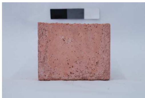
Figura A9 – Imagens digitais do traço CV0_PG1 (a) após a desforma (b) aos 126 dias de idade de exposição à intempérie.
