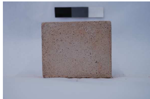
Figura A19 – Imagens digitais do traço CV20_LF10 (a) após a desforma (b) aos 126 dias de idade de exposição à intempérie.
