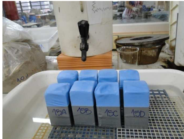
Figura 36 - Execução do ensaio de absorção por capilaridade.
