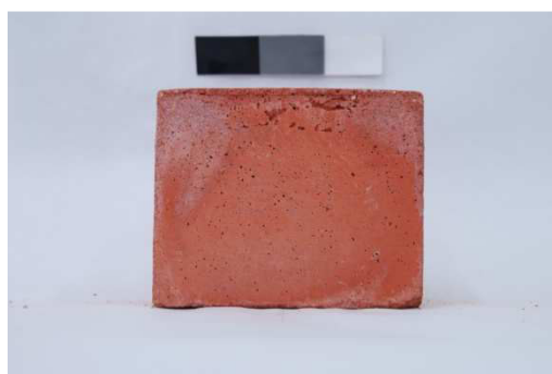
Figura A10 – Imagens digitais do traço CV0_PG5 (a) após a desforma (b) aos 126 dias de idade de exposição à intempérie.
