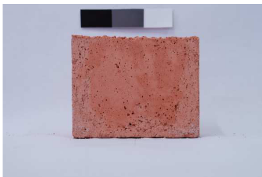
Figura A9 – Imagens digitais do traço CV0_PG1 (a) após a desforma (b) aos 126 dias de idade de exposição à intempérie.
