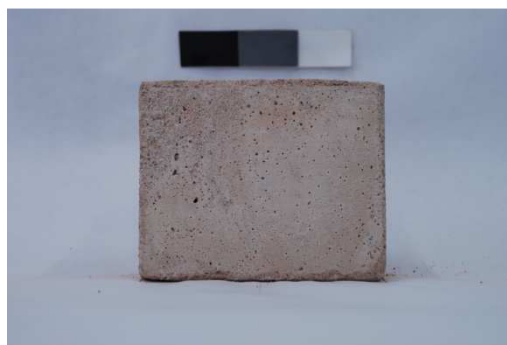
Figura A6 – Imagens digitais do traço CV0_LF5 (a) após a desforma (b) aos 126 dias de idade de exposição à intempérie.
