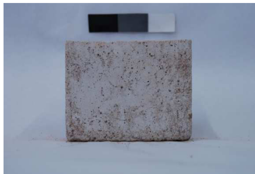
Figura A5 – Imagens digitais do traço REF (a) após a desforma (b) aos 126 dias de idade de exposição à intempérie.
