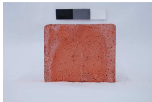
Figura A16 – Imagens digitais do traço CV10_PG5 (a) após a desforma (b) aos 126 dias de idade de exposição à intempérie.
