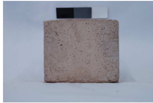
Figura A13 – Imagens digitais do traço CV10_LF10 (a) após a desforma (b) aos 126 dias de idade de exposição à intempérie.
