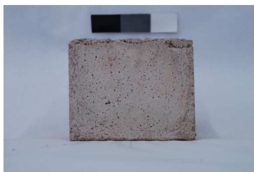
Figura A12 – Imagens digitais do traço CV10_LF5 (a) após a desforma (b) aos 126 dias de idade de exposição à intempérie.
