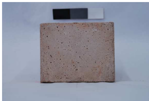
Figura A7 – Imagens digitais do traço CV0_LF10 (a) após a desforma (b) aos 126 dias de idade de exposição à intempérie.
