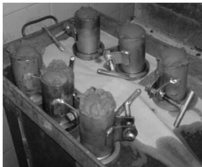
**Figura 22 – Cura inicial após preenchimento dos moldes.**
