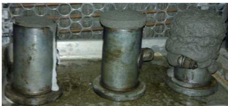
**Figura 17 – Amostras do terceiro traço com cura em estufa a 40°C, durante uma hora.**
