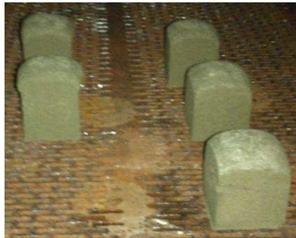
**Figura 30 – Amostras antes do processo de cura em autoclave.**
