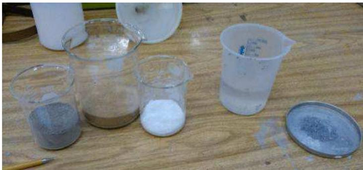
**Figura 11 – Materiais separados e pesados conforme traço.**
