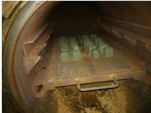
**Figura 46 – Amostras do T1 na autoclave, antes do processo de cura.**
