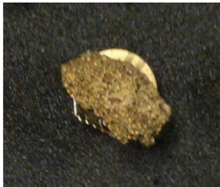
**Figura 52 – Amostra (10 x 10 x 10 mm) de CCA metalizado com ouro paladium.**
