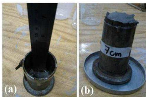
**Figura 13 – (a) Preenchimento do molde respeitando medidas determinadas e (b) identificação.**
