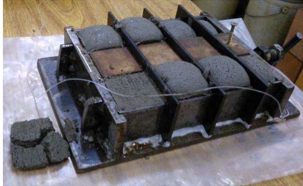
**Figura 45 – Retificação da parte superior das amostras.**
