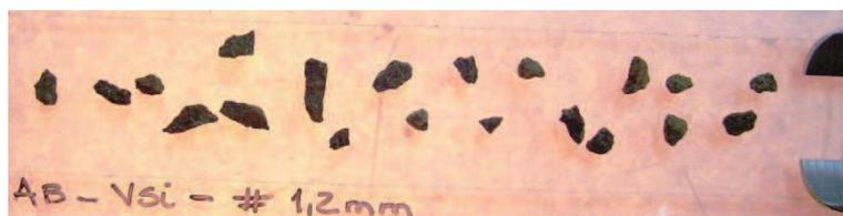
Figura 32 – Amostra ABVSI, retida na peneira de abertura 1,2mm.
