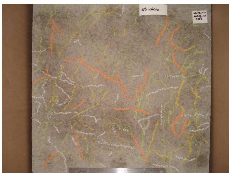
Figura 71 – Análise da fissuração: ABVSI#VSI substrato BbSi
