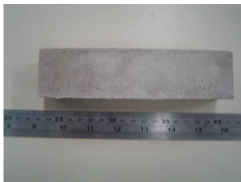
Figura 19 – Corpo de prova onde foi efetuado o ensaio de densidade de massa.
