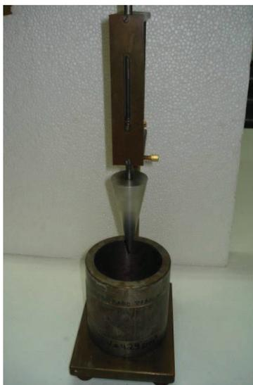
Figura 14 – Equipamento para ensaio de penetração de cone.
