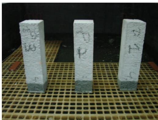
Figura 21 – Ensaio de absorção de água por capilaridade.
