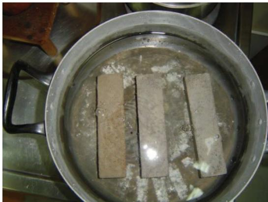
Figura 22 – Ensaio de absorção de água.
