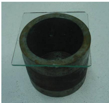
Figura 16 – Equipamento utilizado para o ensaio de densidade de massa.
