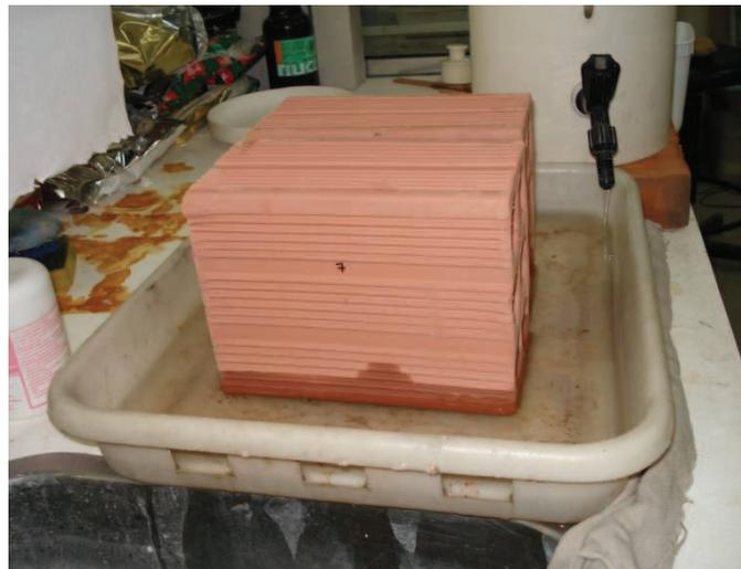
Figura 26– Ensaio de absorção de água por capilaridade dos blocos cerâmicos.
