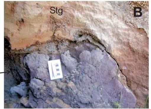
Fig. 3.19 - Litofácies Gm - conglomerado intraformacional: A) intraclastos de grandes dimensões na base de arenitos de estratificação cruzada de grande porte; B) detalhe da figura anterior mostrando o contato entre os mega intraclastos e os arenitos; C) lente de intraclastos em contato com arenitos médios (litofácies Stm).
