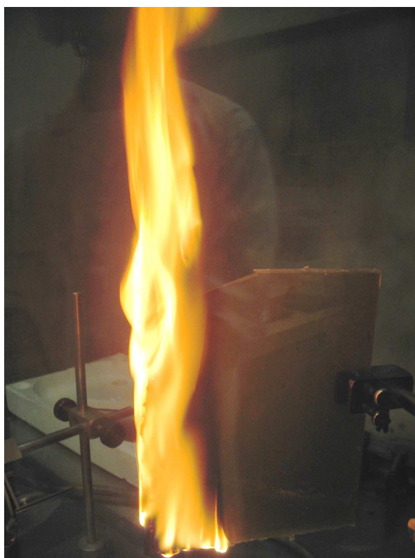
Figura 4.12 – Ensaio de propagação da chama em andamento em uma amostra de resina reciclada a partir do PET pura.
