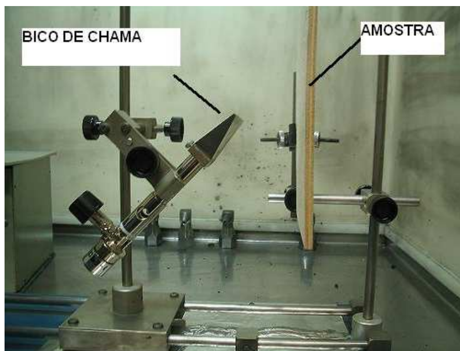
Figura 3.8 - Protótipo para realização do ensaio de propagação de chama (LABELO – PUC/RS).
