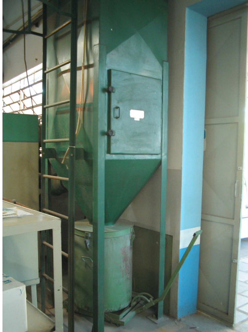
Figura 3.4 - Sistema de captação do resíduo da alumina de polimento que suga o resíduo após o polimento das peças metálicas.
