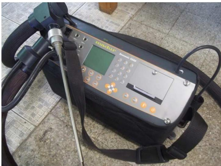
Figura 3.5 – Analisador de gases.
