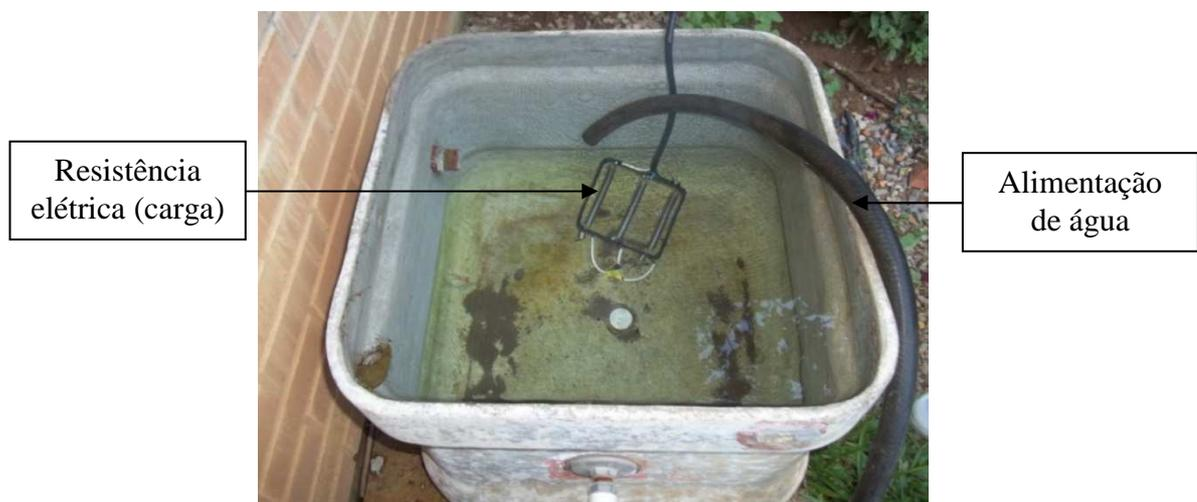
Figura 3.10 – Reservatório de água e resistência elétrica.
