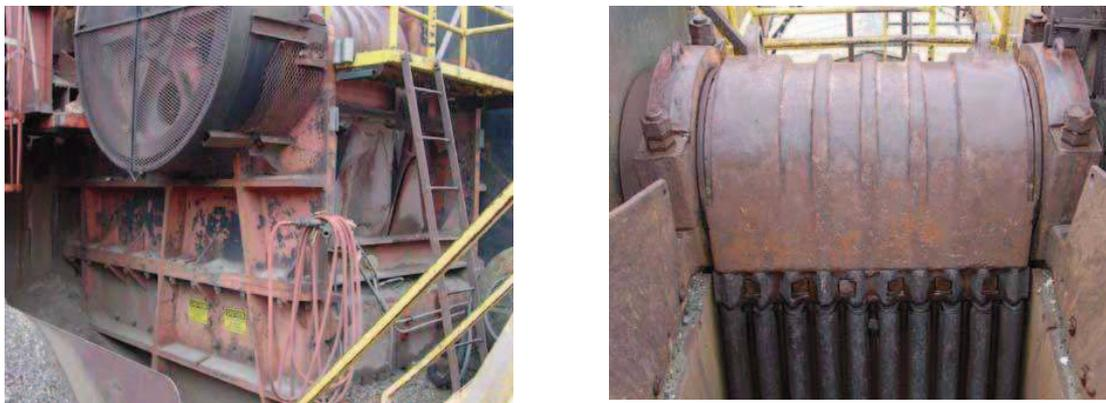
**Figura 2 - Britador de Mandíbula com alta capacidade de produção**
