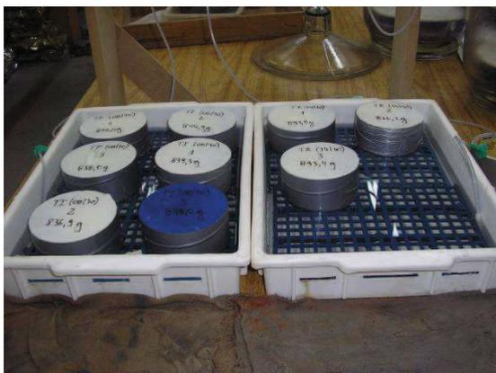
Figura 27 - Sistema de absorção de água por capilaridade.
