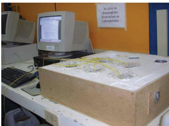
**Figura 29 – Amostras dispostas no compartimento isolado, acopladas a termopares.**
