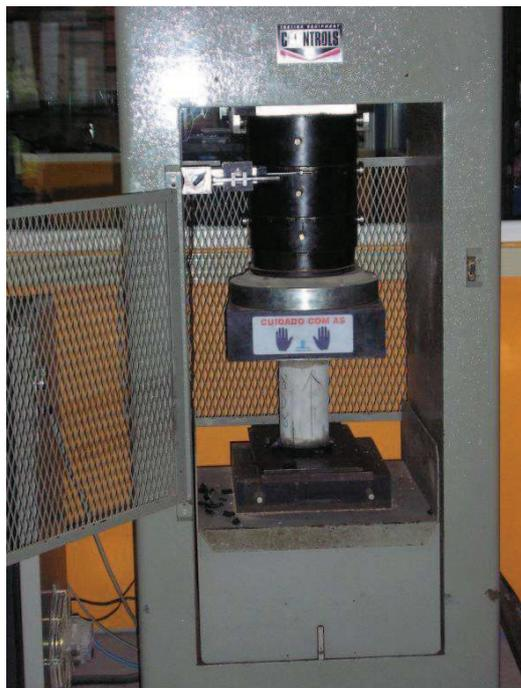
**Figura 24 - Ensaio de resistência à compressão axial.**
