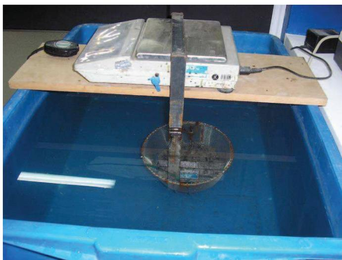
**Figura 11 - Visualização da análise de absorção de água dos agregados reciclados de concreto em balança hidrostática.**
