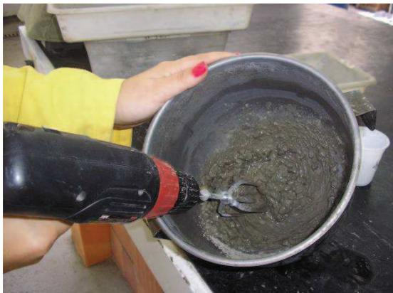
**Figura 28 – Preparação de amostras para o ensaio de monitoramento da temperatura das reações de hidratação.**
