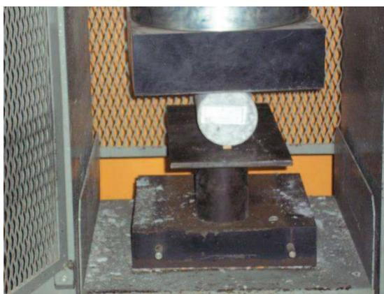
**Figura 25 - Ensaio de resistência à compressão por tração diametral.**
