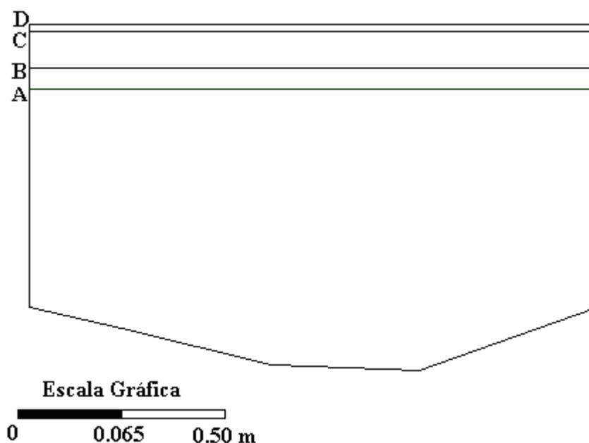
Figura 14 - Perfil de fundo de P2, com suas lâminas d'água para as diferentes estações do ano.
