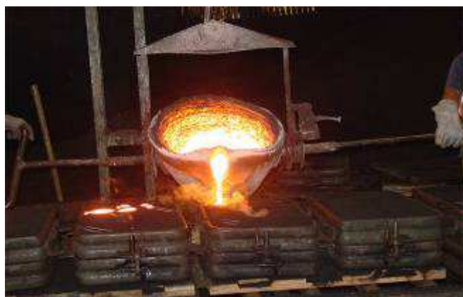
Figura 6 - Molde com areia sendo preenchido com metal líquido
