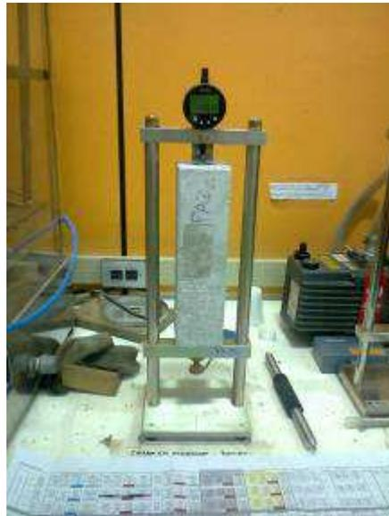
**Figura 19 – Equipamento para medidas de deformação com cp.**
