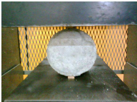
**Figura 15 – Ensaio de tração.**
