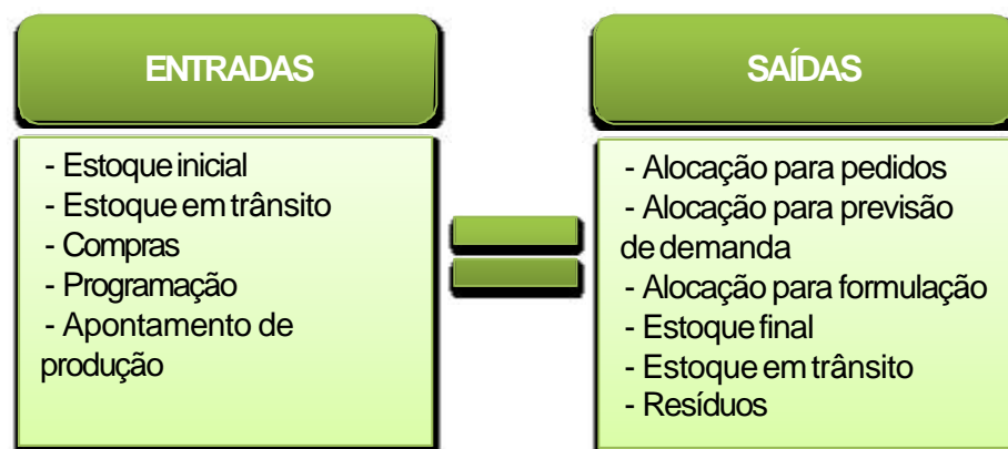
FIGURA 19 – Estrutura simbólica do balanço de massas
