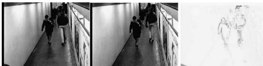
Figura 2.2 – Detecção de objetos por diferença temporal, conforme Valera e Velastin [1].
