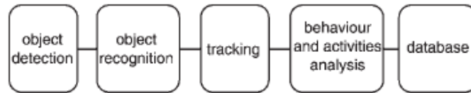
Figura 2.1 – Processos envolvidos em um sistema de segurança conforme Valera e Velastin [1].
