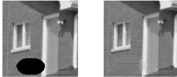
Figura 5.1: Reprodução de áreas com texturas. A região de inpainting (área escura da figura à esquerda) é reconstruída (figura à direita) pelo método pixel-a-pixel. Contudo, a textura não é sintetizada satisfatoriamente, exagerando as linhas da estrutura que se destaca na vizinhança da região de inpainting.
