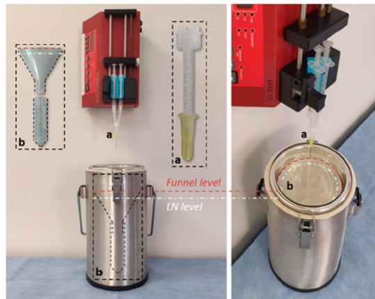
Figura 8 - Método de vitrificação por gotejamento proposto por Vries et al. (2019).
