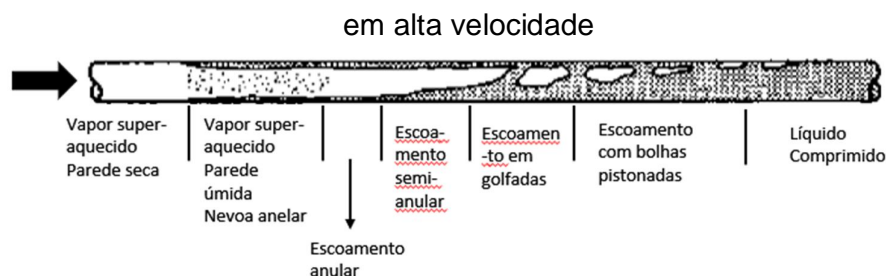
Figura 19 - Padrão de escoamento bifásico em condensação para tubos horizontais
