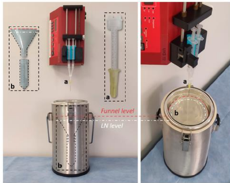
Figura 2.11 – Método de vitrificação por gotejamento proposto por Vries et al. (2019).
