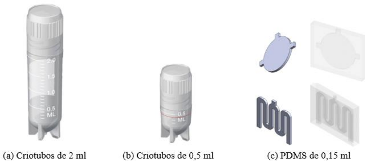
Figura 3.8 - Criotubos e dispositivos de PDMS utilizados no processo de vitrificação por imersão direta.
