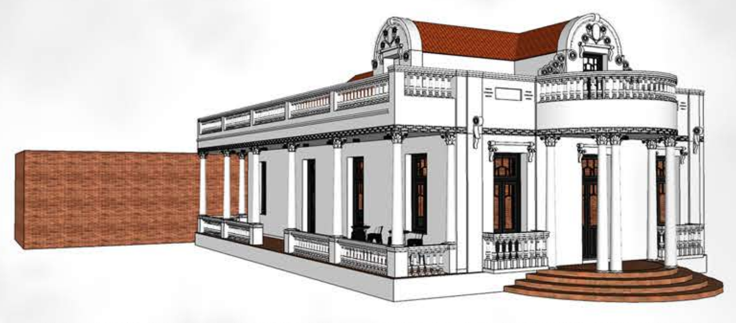
O volume da garagem foi ampliado, afim de abrigar a cozinha e o setor administrativo do restaurante. Além disso, propõem-se que o mesmo seja revestido com plaquetas de tijolo de barro, criando um pano de fundo que conversa com os tons terrosos (piso entrada e varanda e telha) já existentes na residência.
