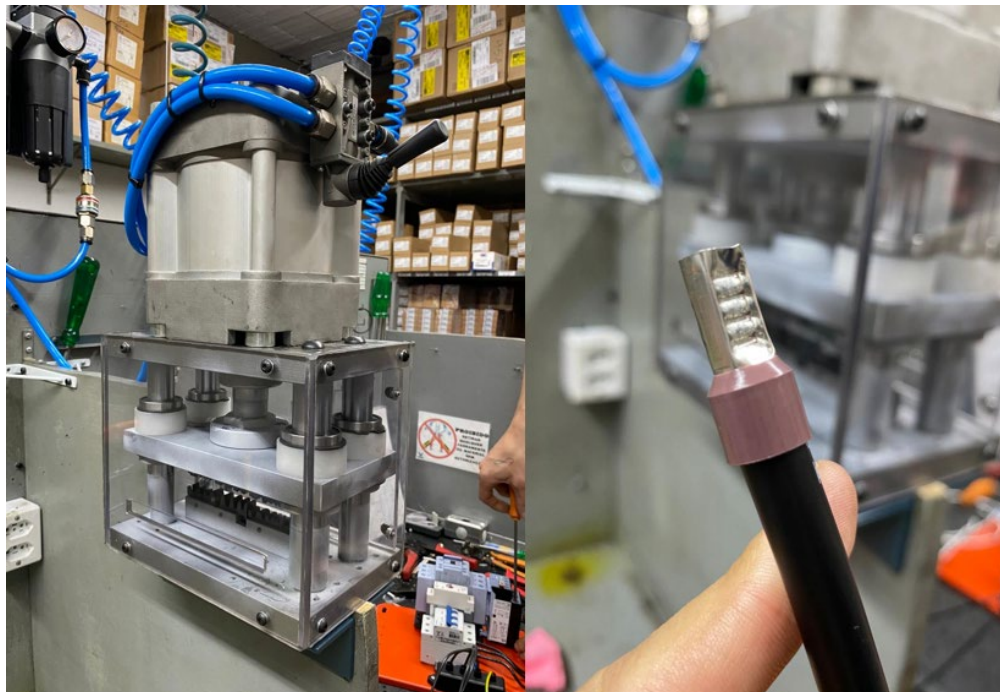
Figura 12 - Dispositivo instalado e cabo crimpado
