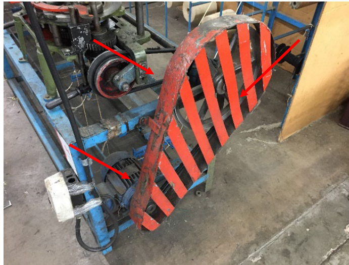
Figura 3 – A máquina possui carcaça descontínua, com abertura que permite acesso ao movimento da transmissão de força.
