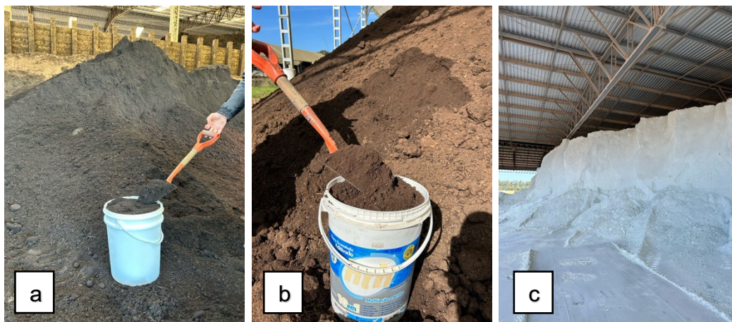
Figura 3 – Resíduos: (a) Casca de eucalipto, (b) Resíduo do lodo da ETE e (c) Lama de Carbonato de Cálcio
