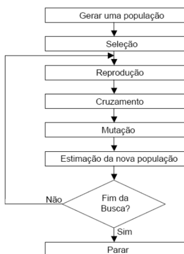
Figura 1 - Fluxograma que descreve brevemente um algoritmo genético.
