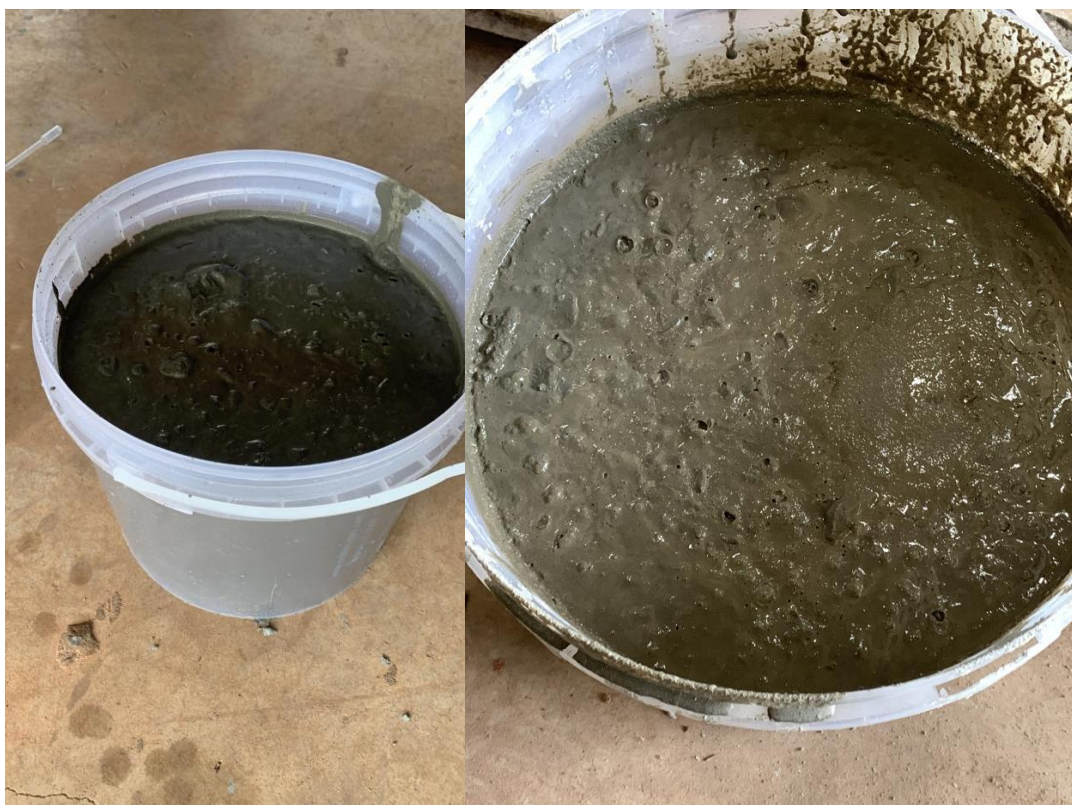
Figura 25 – Diferentes exsudações nos concretos
