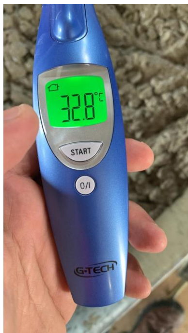
(a) Temperatura do concreto
