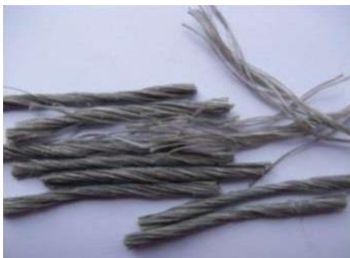
Figura 13 – Feixes de macrofibras de polipropileno
