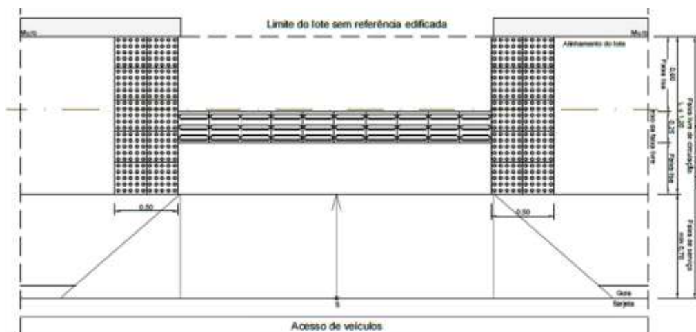
Figura 44 – Ausência ou descontinuidade de referência edificada
