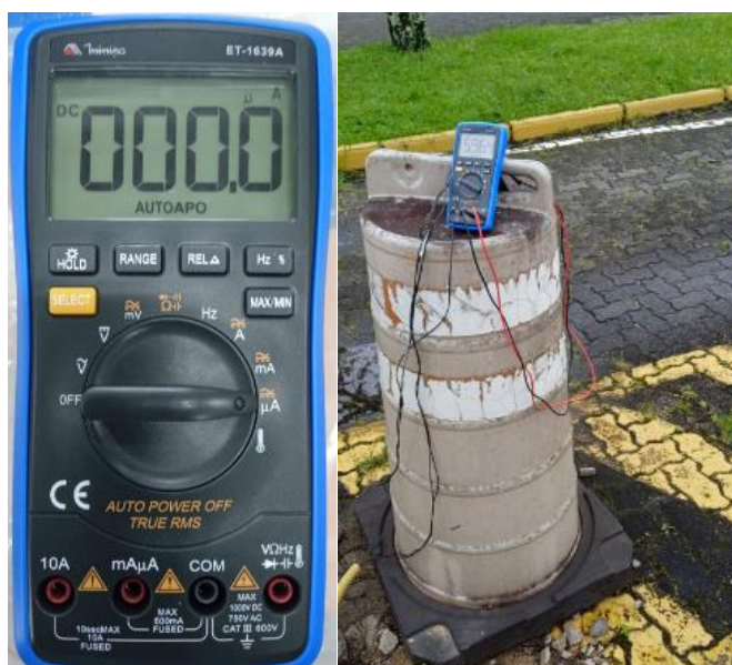
Fotografia 13 - Multímetro utilizado para as aferições
