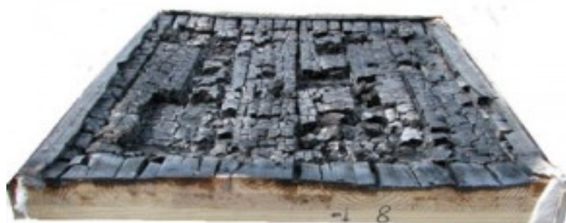
Figura 11 – Seção de estrutura CLT carbonizada
