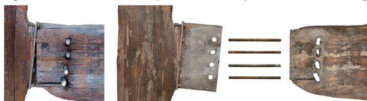
Figura 32 – Modelo experimental após o teste ao fogo
