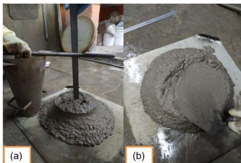
Figura 21 – Ensaio de abatimento (a) e aspecto visual (b) do concreto fresco
