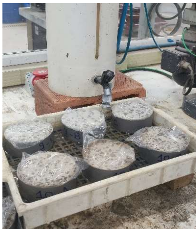
Figura 12 – Ensaio de absorção de água por capilaridade
