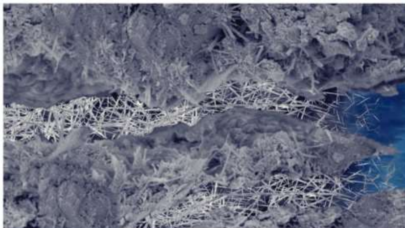
Figura 4 – Exemplo de cicatrização na presença de aditivo cristalizante
